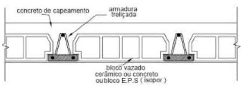
Figura 4 - Corte da laje treliçada.
