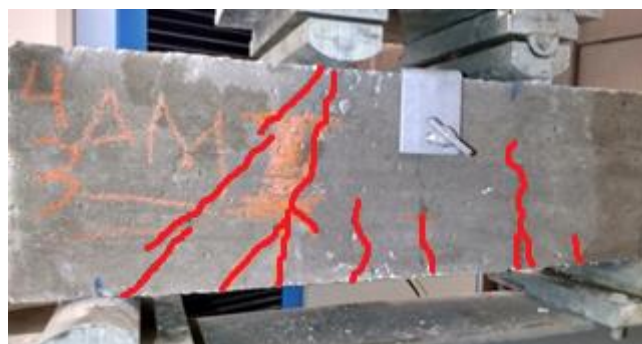
Figura 30 – V04-C fissuras após o ensaio.
