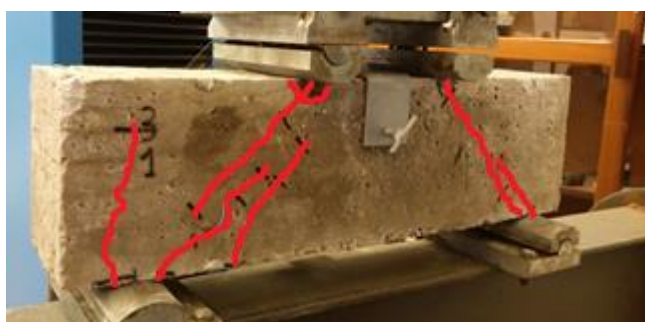
Figura 24 – V03-A fissuras após o ensaio.
