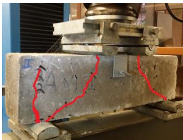
Figura 21 – V02-B fissuras após o ensaio.
