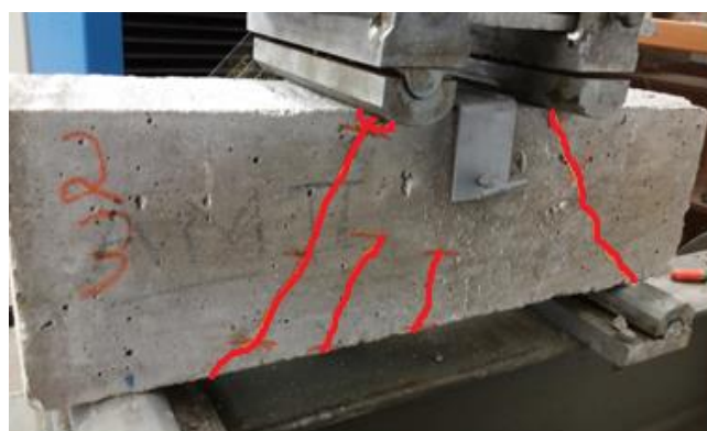
Figura 22 – V02-C fissuras após o ensaio.
