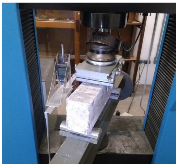
Figura 13 – Ensaio da viga vista frontal.
