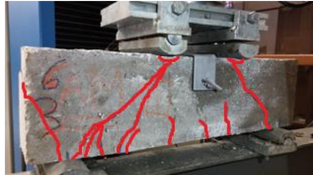
Figura 38 – V06-C fissuras após o ensaio.
