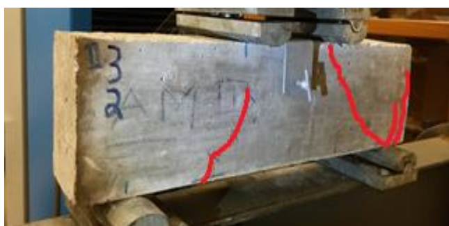
Figura 25 – V03-B fissuras após o ensaio.
