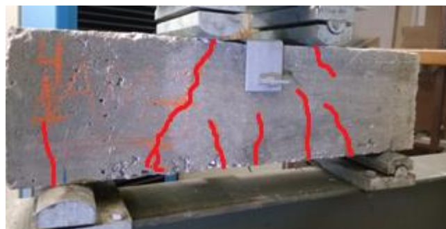
Figura 28 – V04-A fissuras após o ensaio.
