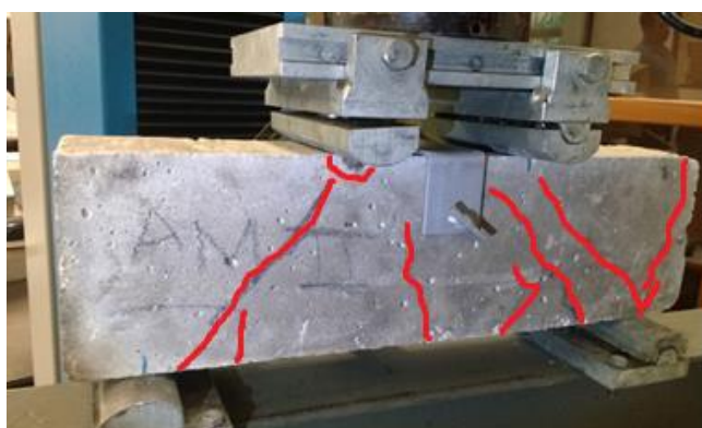
Figura 20 – V02-A fissuras após o ensaio.
