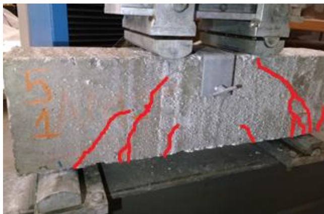
Figura 32 – V05-A fissuras após o ensaio.
