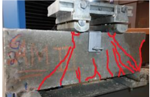
Figura 37 – V06-B fissuras após o ensaio.
