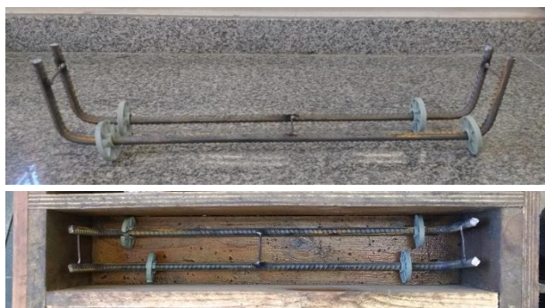
Figura 7 – Armadura V01 sem estribos, somente armadura principal 2 Ø 10,0 mm.
