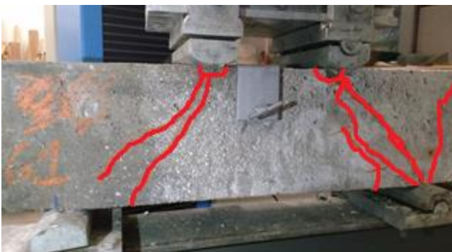
Figura 36 – V06-A fissuras após o ensaio.
