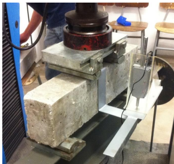
Figura 14 – Ensaio da viga vista dos fundos.
