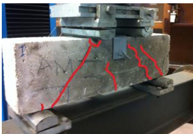
Figura 16 – V01-A fissuras após o ensaio.
