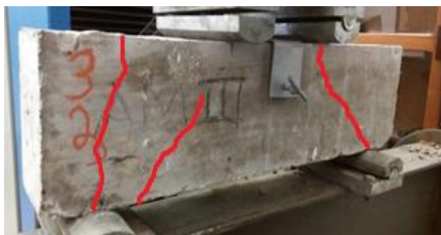
Figura 26 – V03-C fissuras após o ensaio.
