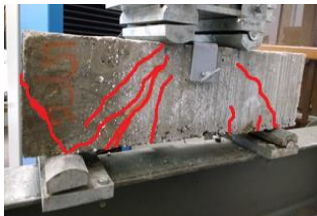
Figura 33 – V05-B fissuras após o ensaio.
