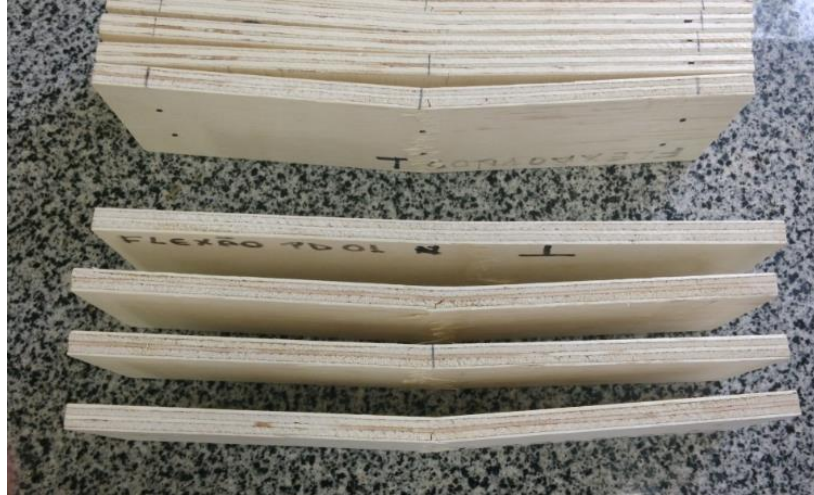
Figura 42 - Corpos de provas rompidos
