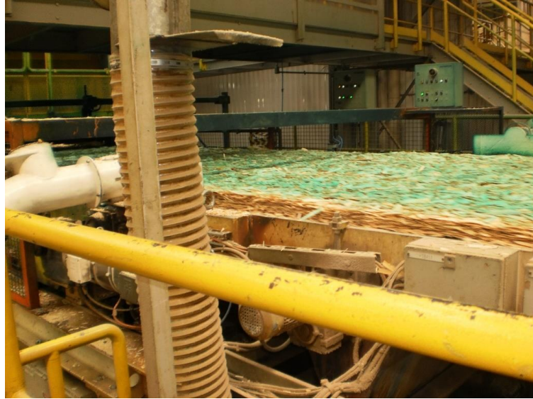
Figura 17 - Processo de Prensagem da chapa de OSB
