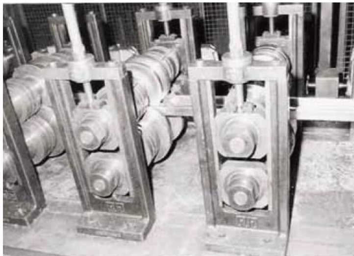
Figura 11 - Máquina usadas para fabricação dos perfis seção Ue
