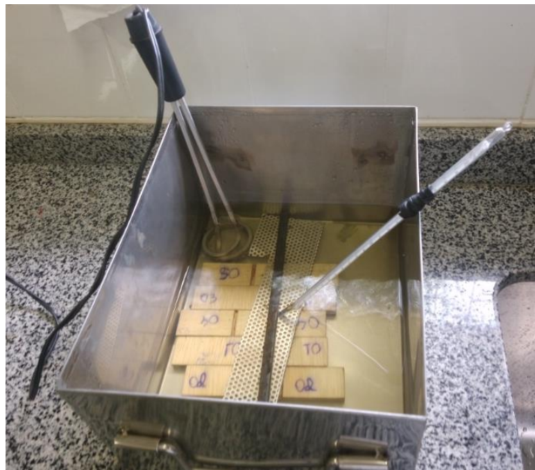
Figura 45 - Imersão do Corpo de Prova em água em ebulição
