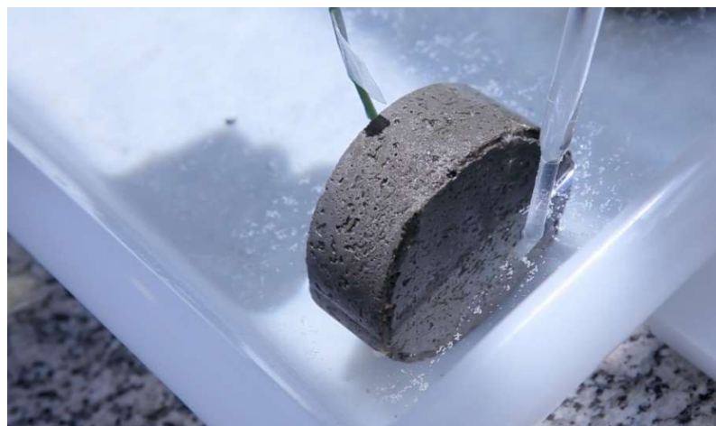
Figura 48: Método eletroquímico (IPT, 2014)
