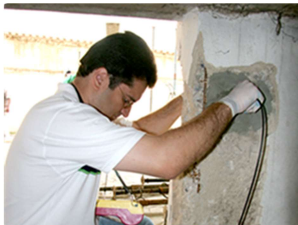
Figura 39: Ensaio de ultrassom (ULTRALAB, 2014)
