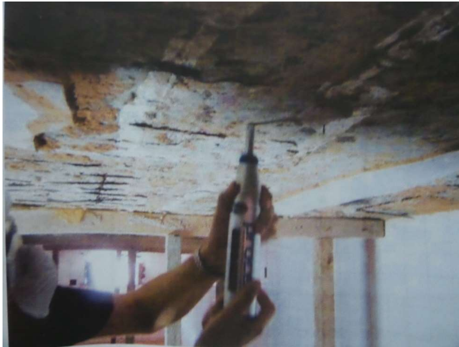
Figura 38: Ensaio de esclerometria realizado na Biblioteca Benedito Leite em São Luís/MA (AGUIAR, 2010)
