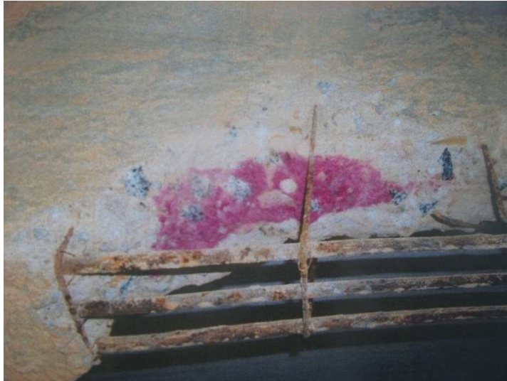
Figura 45: Ensaio com fenolftaleína (LUCENA, 2011)
