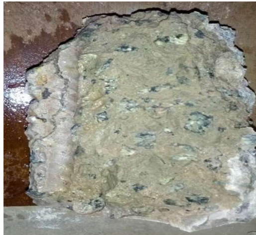
Figura 46: Corpo de prova submetido à água do mar aspergido de nitrato de prata (NOGUEIRA, 2013)
