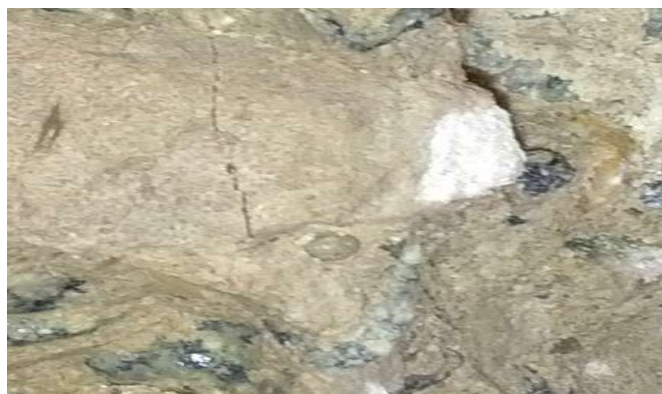
Figura 47: Formação de precipitado branco (NOGUEIRA, 2013)
