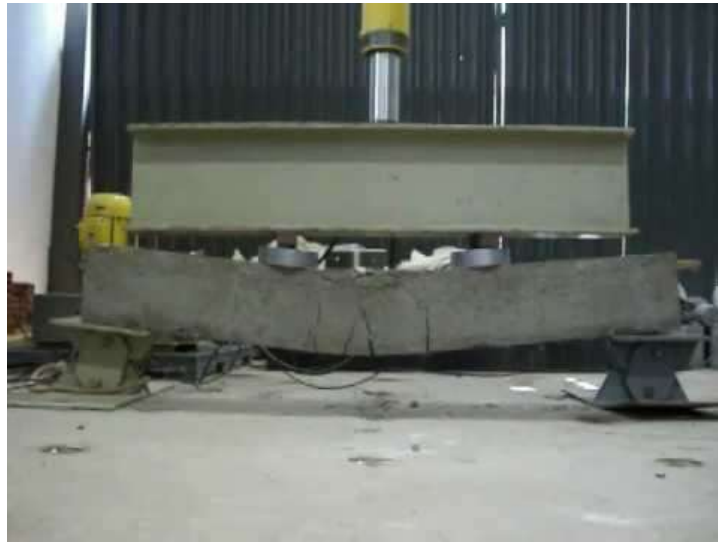
Figura 20: Fissuras de flexão em teste de carga em viga
