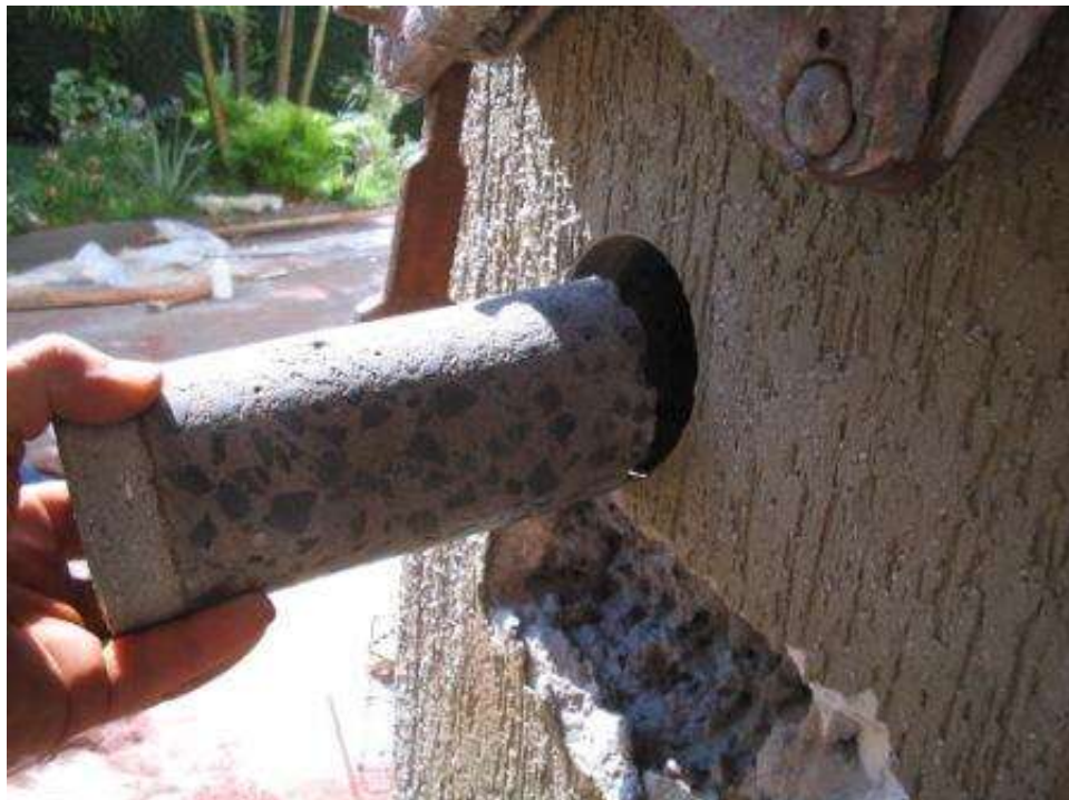
Figura 42: Extração de testemunho (RODRIGUES, 2012)
