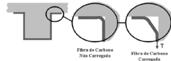
Figura 8.11 – Comportamento do sistema CFC em cantos internos.
