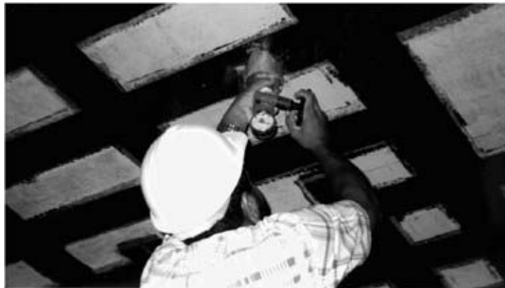
Fotografia 9.14 – Teste de arrancamento do sistema composto aplicado.
