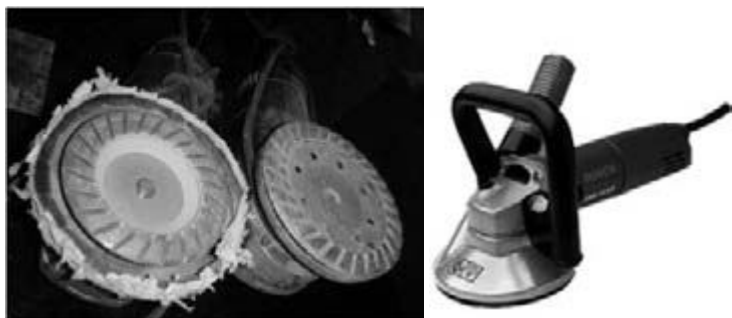
Fotografia 3.2 – Detalhe da politriz elétrica e do aspirador de pó.
