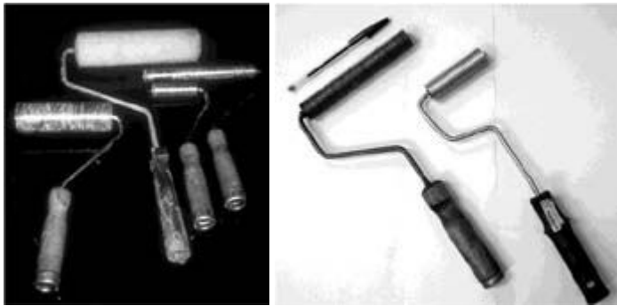
Fotografia 3.4 – Ferramental utilizado para aplicar o sistema composto.
