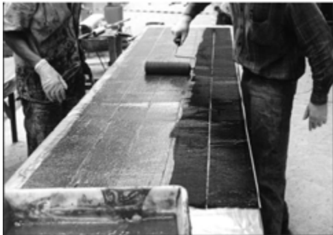
Fotografia 3.3 – Saturação da fibra de carbono na bancada.
