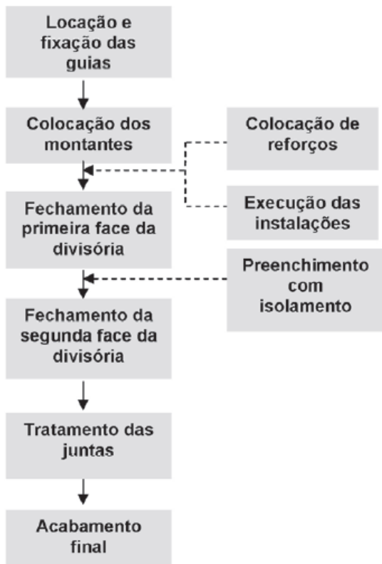
Figura 58: Sequência de montagem do sistema Drywall.
