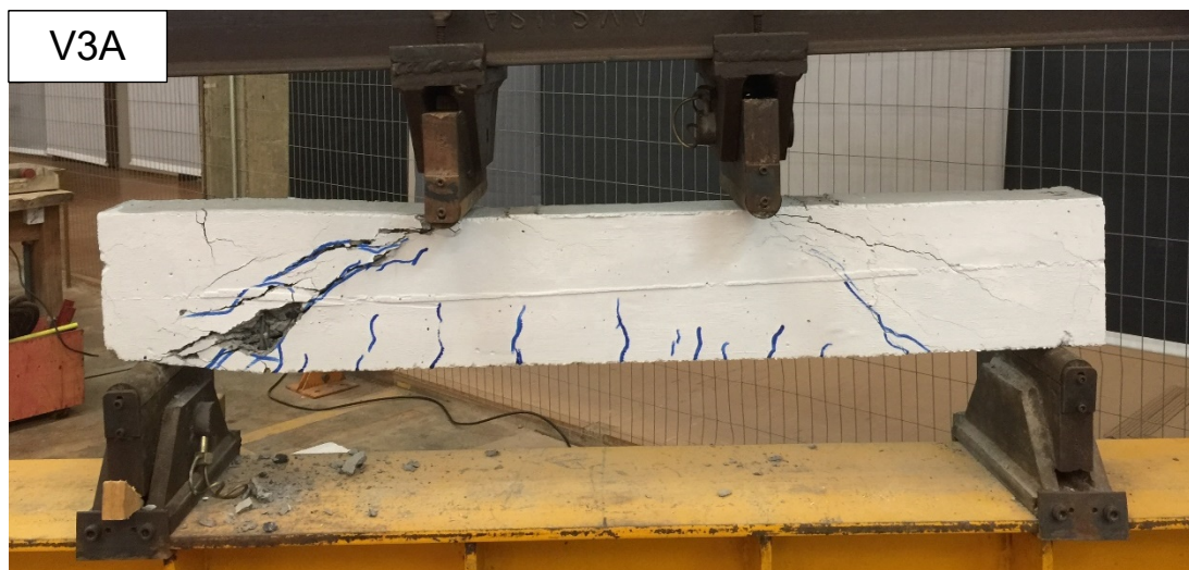
Figura 33: Padrão de fissuração - V3A Fonte: Autoria própria, 2018.
