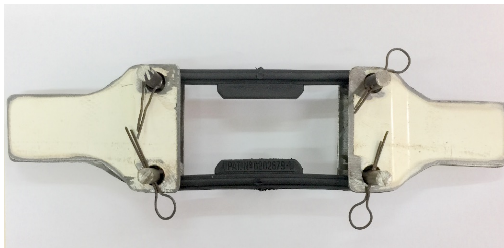
Figura 20: Dispositivo utilizado para ensaio de tração dos estribos de plástico Fonte: Autoria própria, 2018.
