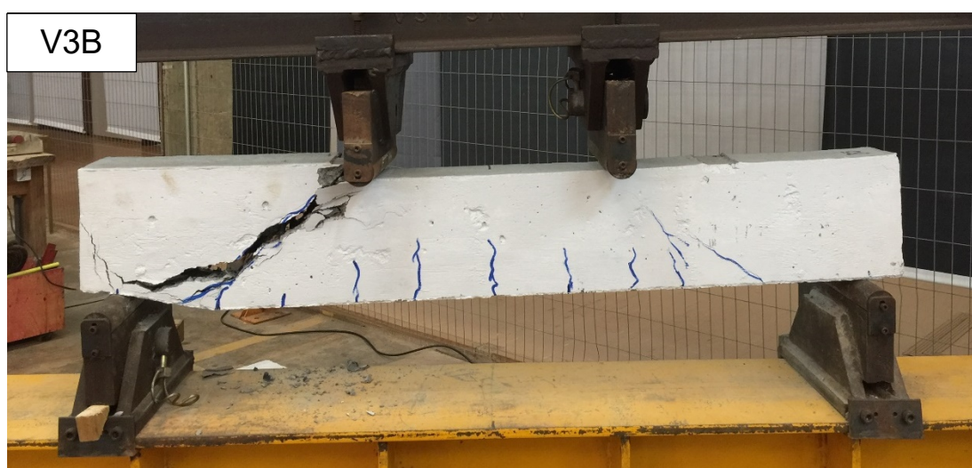
Figura 36: Padrão de fissuração - V3B Fonte: Autoria própria, 2018.
