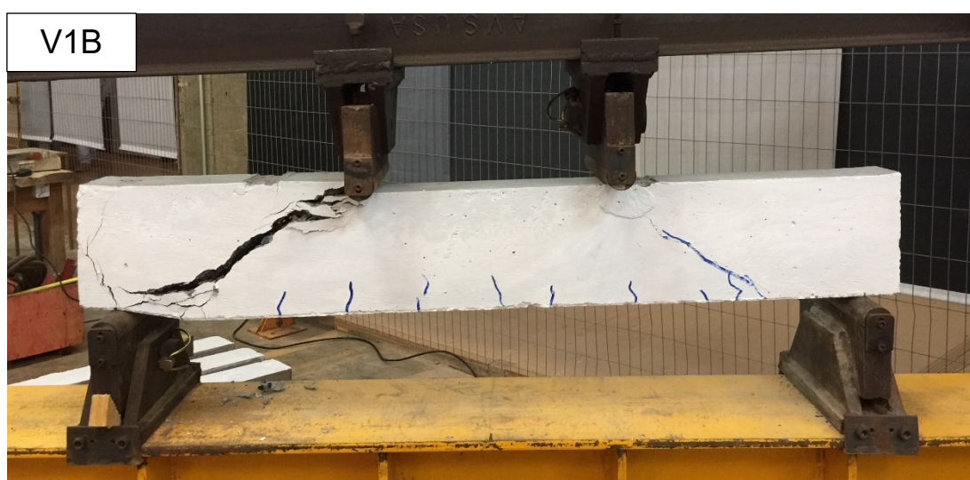
Figura 34: Padrão de fissuração - V1B Fonte: Autoria própria, 2018.
