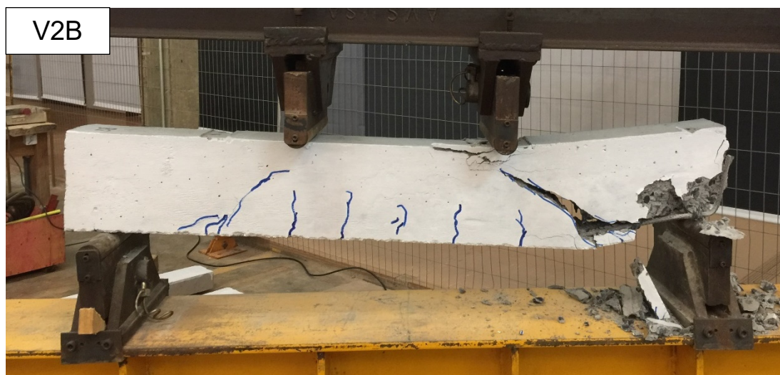
Figura 35: Padrão de fissuração - V2B Fonte: Autoria própria, 2018.
