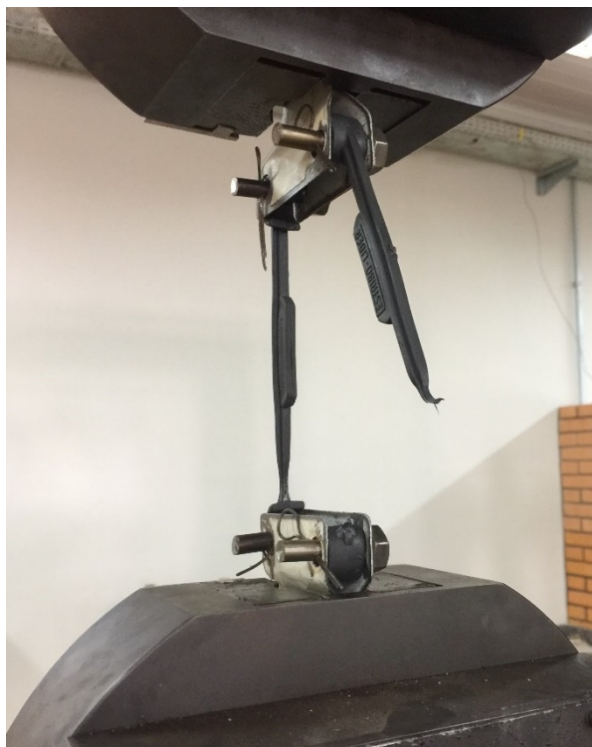
Figura 29: Ruptura dos estribos de plástico no ensaio a tração Fonte: Autoria própria, 2018.
