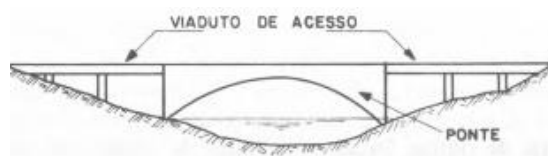
Figura 1- Estrutura principal (ponte) e viadutos de acesso.
